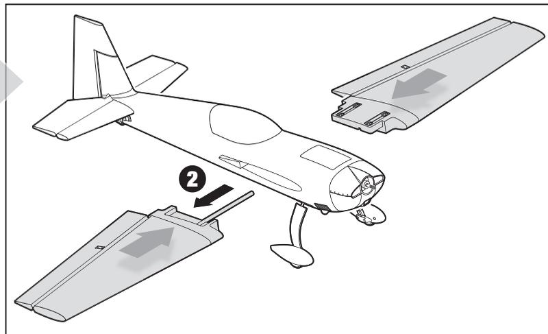
3. Die Tragflächen mit vier 3 x 30mm Schrauben am Rumpf sichern.
