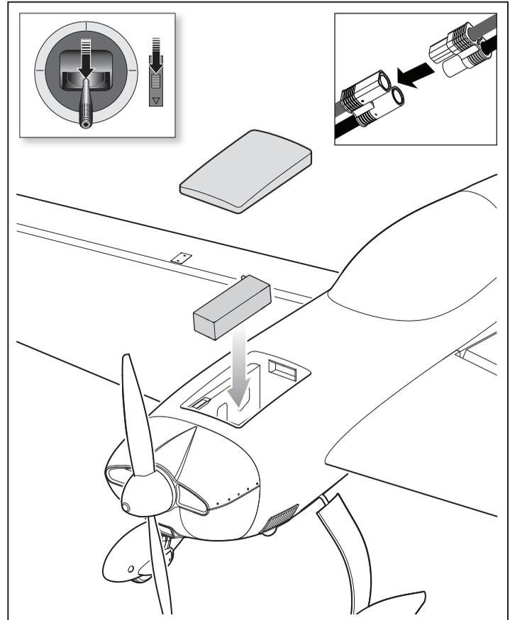
**VORSICHT:** Die Hände immer vom Propeller fernhalten. Der Motor reagiert im eingeschalteten Zustand auf eine Bewegung des Gashebels mit einer Drehung des Propellers.
