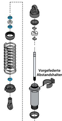
Sie die Fahrhöhe so ein, dass sich die Federarme etwas über der Parallele zum Boden befinden. Beobachten Sie, wie sich das Modell in Kurven verhält. Die richtige Einstellung wird das Modell stabilisieren und Spin-Outs verhindern. Experimentieren Sie mit unterschiedlichen Federn und Stoßdämpferölen, um herauszufinden, was für Ihren Streckenbedingungen am besten funktioniert.
