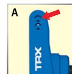
minimieren. Wenn sie das obere Loch am C-Träger (Abbildung A) und eins der beiden unteren Löcher am Stoßdämpfer (Positionen 3 oder 4 in der Abbildung "Vorne") verwenden, sollte die Spurstangenkugel mit dem großen flachen Ende oben ausgerichtet werden (Werkseinstellung - Abbildung B). Wenn Sie eine andere Kombination von Spurstangenaufnahmepunkten verwenden, sollte die Spurstangenkugel mit dem großen flachen Ende unten (C) ausgerichtet werden.
