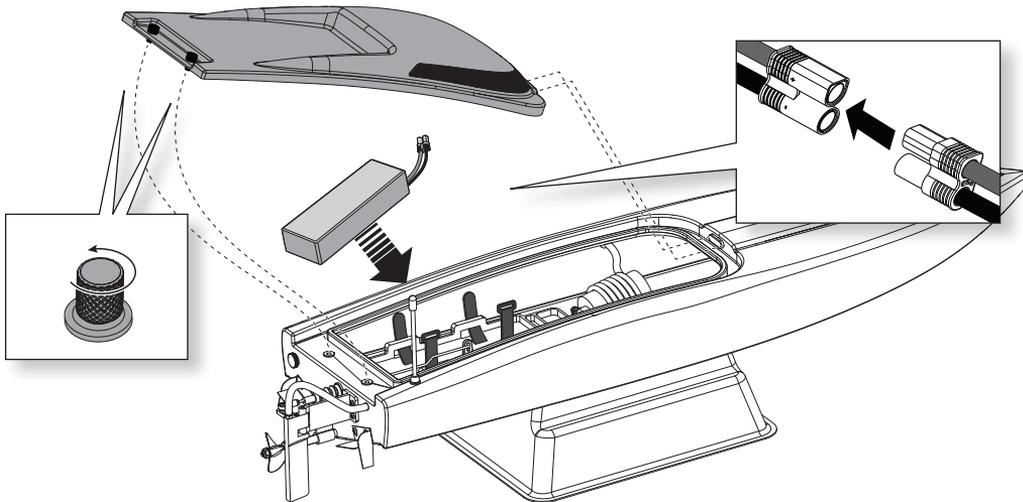
**Tipp:** Bewegen Sie den Akkupack nach vorne oder hinten um den Schwerpunkt des Bootes einzustellen. Schieben Sie die Akkus weiter nach vorne, taucht der Bug tiefer in das Wasser ein. Schieben Sie die Packs nach hinten, hebt sich der Bug weiter aus dem Wasser.
