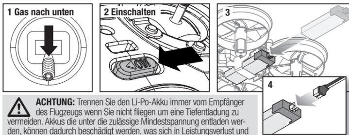
**ACHTUNG:** Trennen Sie den Li-Po-Akku immer vom Empfänger des Flugzeugs wenn Sie nicht fliegen um eine Tiefentladung zu vermeiden. Akkus die unter die zulässige Mindestspannung entladen werden, können dadurch beschädigt werden, was sich in Leistungsverlust und potentieller Brandgefahr bei dem Laden bemerkbar machen kann.
