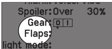
**Tipp:** Der schwarze Punkt unter dem Kästchen zeigt die aktuelle Schalterposition. Drehen und drücken den Rolltasters markiert die Box schwarz und zeigt damit an, dass der Wert oder die Bedienung auf dieser Position liegt.
