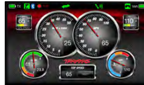
Das anpassbare Traxxas-Link-Armaturenbrett zeigt Daten für Drehzahl, Geschwindigkeit, Temperatur und Spannung in Echtzeit an.
