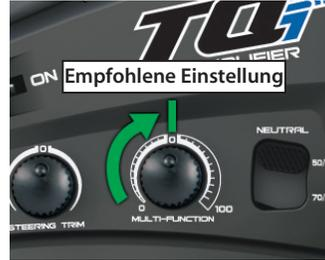
Drehen Sie den Schalter im Uhrzeigersinn, um die Hilfeleistung zu erhöhen, oder gegen den Uhrzeigersinn, um die Hilfeleistung zu verringern. Drehen Sie den Multifunktionsschalter bis zum Endpunkt gegen den Uhrzeigersinn, um TSM vollständig auszuschalten.
