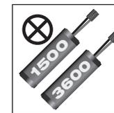
Vermischen Sie nicht Batterien mit unterschiedlicher Kapazität. Benutzen Sie zwei Batterien mit der gleichen Kapazität.
