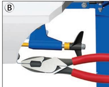
Um die Trimmklappen einzustellen, greifen Sie sie sicher mit einer Zange, so nah wie möglich an der Beuge. Biegen Sie die Trimmklappe nach unten, um einen neuen Winkel einzustellen. Beachten Sie, dass die Trimmklappe ein bisschen zurück federt. Deshalb müssen Sie die Trimmklappe etwas weiter nach unten biegen als in die Position, die Sie wünschen.
