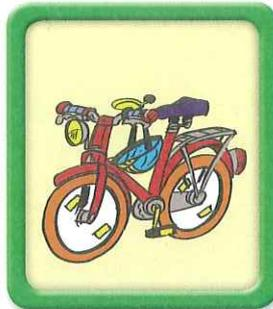
Das Fahrrad entspricht den Sicherheitsvorschriften: Das Licht funktioniert, in den Speichen sind Reflektoren, es gibt Schutzbleche sowie eine Klingel und die Bremsen funktionieren.
