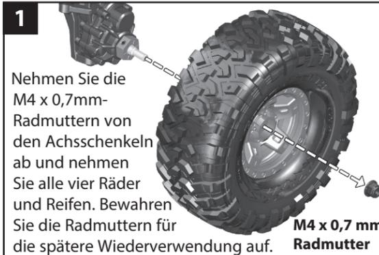
Nehmen Sie die M4 x 0,7mm-Radmuttern von den Achsschenkeln ab und nehmen Sie alle vier Räder und Reifen. Bewahren Sie die Radmutter für die spätere Wiederverwendung auf.
