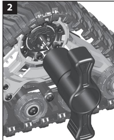
Entfernen Sie die Achsschenkelmuttern aus den Traxx-Antriebseinheiten mit dem mitgelieferten 17mm Radmutternschlüssel.
