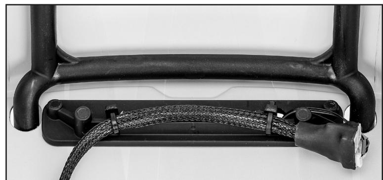
Verkabelung der hinteren Lichtleiste / langes Anschlusskabel an der hinteren Lichtleistenhalterung montiert
