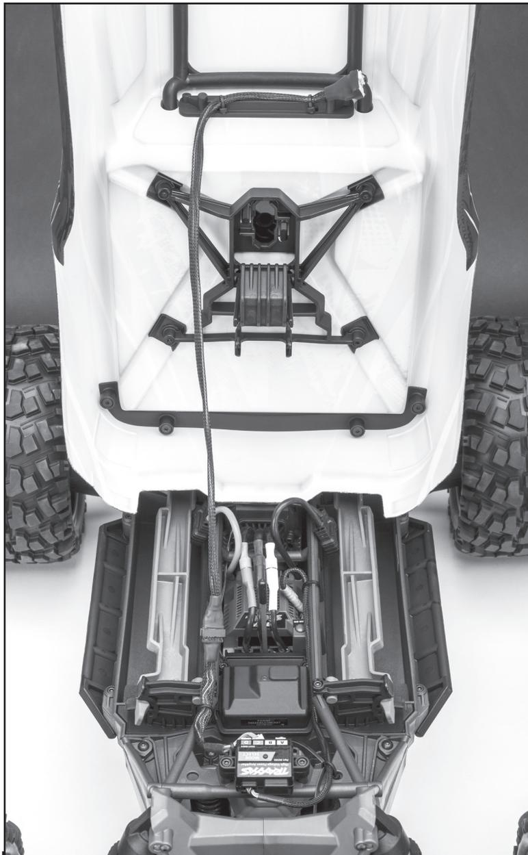
**Langes und kurzes Anschlusskabel an Netzteil für LED-Lichter angeschlossen**
