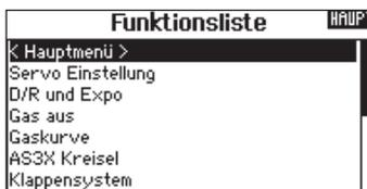
2. Wechseln Sie in der Funktionsliste in das AS3X Menü. Ist ein AS3X Empfänger an den Sender gebunden und Sender und Empfänger sind eingeschaltet, werden die Live Gainwerte auf dem Display dargestellt.
