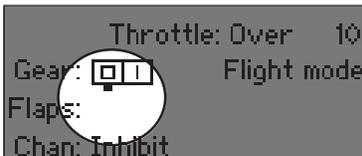
**Tip:** Der schwarze Punkt unter dem Kästchen zeigt die aktuelle Schalterposition. Drehen und drücken den Rolltasters markiert die Box schwarz und zeigt damit an, dass der Wert oder die Bedienung auf dieser Position liegt.
