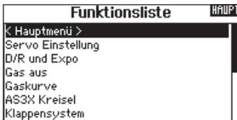
2. Wechseln Sie in der Funktionsliste in das AS3X Menü. Ist ein AS3X Empfänger an den Sender gebunden und Sender und Empfänger sind eingeschaltet, werden die Live Gainwerte auf dem Display dargestellt.
