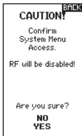
Betätigen und halten Sie das Scrollrad, während der Sender eingeschaltet wird, um die „System Setup“-(Systemkonfiguration-)Liste anzuzeigen. Es treten keine Funkübertragungen auf, wenn ein „System Setup“-(Systemkonfiguration-)Bildschirm angezeigt wird, um unbeabsichtigte Schäden an den Gestängen und Servos während der Änderungen an der Programmierung zu vermeiden.
