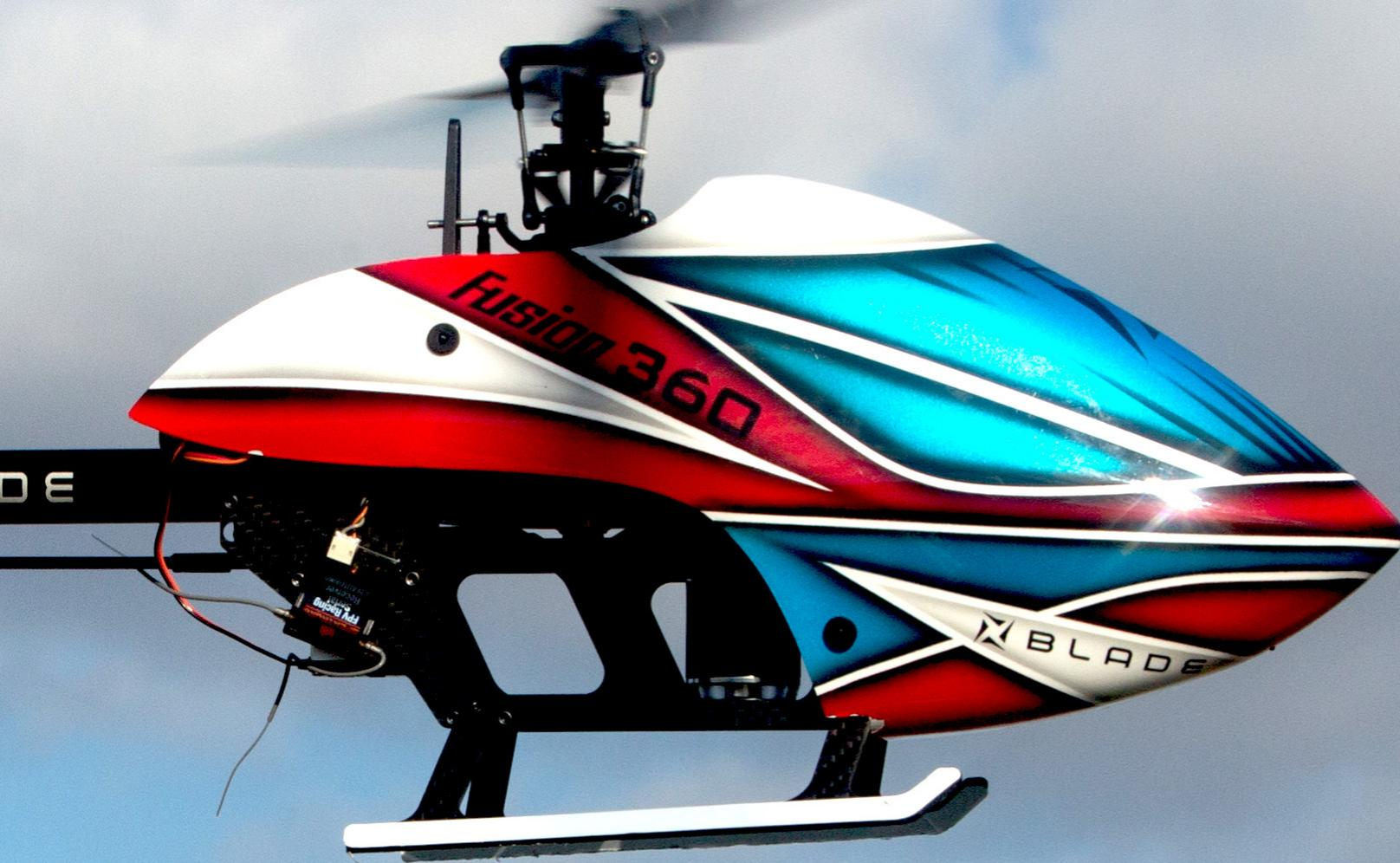
Ein neues, übergroßes Heckrohr macht Heckabstreibungen unnötig und wird durch ein neues CNC-gefrästes Aluminium Heckgetriebegehäuse gekrönt, das die Vibrationsdämpfung und die Leistung verbessert. Die lackierte Kohlefaser-Heckfinne und GFK Haube bieten den dynamischen Fusion-Look, der selbst am Boden schon energiegeladen aussieht. Dieses großartige Re-Design kommt als BNF Basic-Paket, wie es Blade-Kunden erwarten, fertig montiert, um aus der Box heraus flugfertig mit Performance zu überzeugen.
